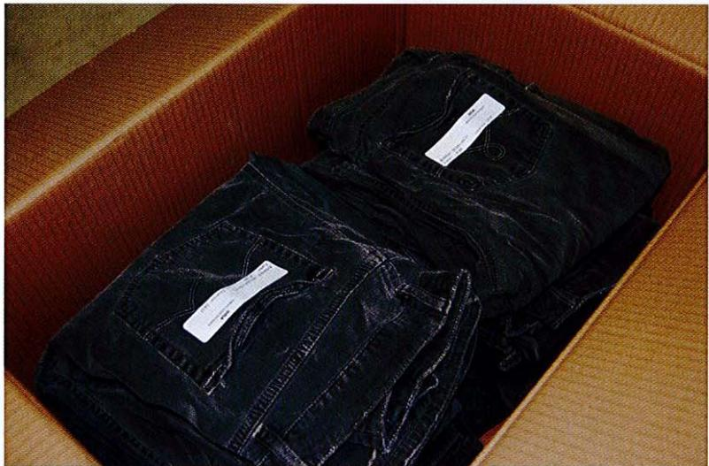
Abbildung 1: Bekleidungsstücke mit selbstklebenden RFID Papiertranspondern
