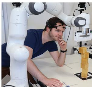
GmbH & Co. KG eine neuartige Brain-Computer-Schnittstelle für die Mensch-Roboter-Interaktion. Diese erfasst die Gehirnströme des Menschen und ermöglicht es so, die Interaktion an dessen mentalen Zustand und damit an die jeweils aktuelle Leistungsfähigkeit des Menschen anzupassen – für mehr Sicherheit am Arbeitsplatz.
